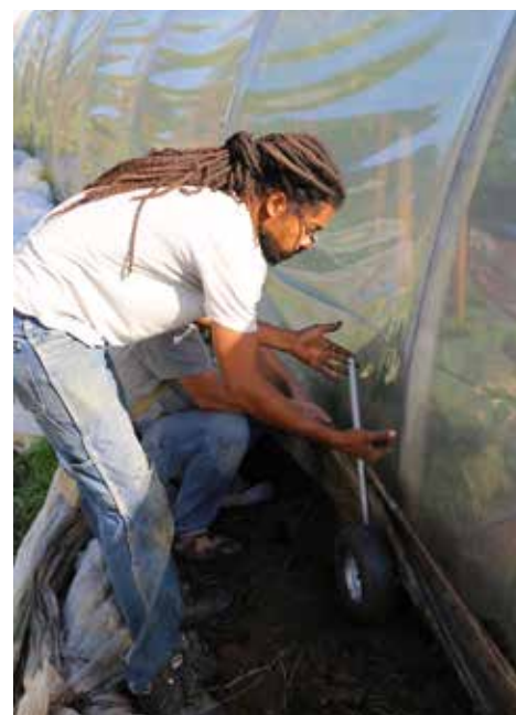
Tristan Toe von BIOSain führt seinen Rolltunnel vor, der auf Rädern fährt. Hier ist das Heberad mit dem Stahlhebel zu sehen, das angesteckt wird und den Tunnel vom Boden hebt (© Wolfgang Palme, HBLFA Schönbrunn)
