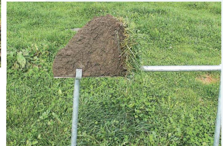
Abbildung 11: Mit einem Flachspaten entnommener Bodenziegel
